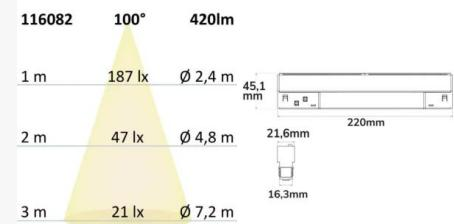
**Spécificités:** Fonctionnement uniquement à une source de tension constante non modulable de 48 V. Adapté à tous les rails "Track48".
