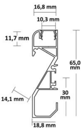
**Spécificités:** IMPORTANT: La surface adhésive doit être dégraissée avant utilisation! Le profilé doit être fixé tous les 40 cm afin d'éviter les risques de dilatation. La LED doit être collée sur une surface dégraissée délicatement sans être pliée. Le collage du ruban s'effectue toujours hors tension. Masse frigorifique = 612 grammes/mètre, Conçu pour les bandes flexibles LED d'une largeur maximale de 16 mm. Eclairage direct et indirect en remplacement des plinthes.
