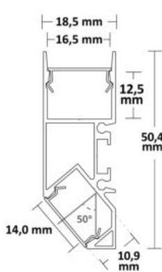
**Spécificités:** IMPORTANT: La surface adhésive doit être dégraissée avant utilisation! Le profilé doit être fixé tous les 40 cm afin d'éviter les risques de dilatation. La LED doit être collée sur une surface dégraissée délicatement sans être pliée. Le collage du ruban s'effectue toujours hors tension. Masse frigorifique = 450 grammes/mètre, Conçu pour les bandes flexibles LED d'une largeur maximale de 16 mm.
