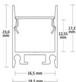
**Spécificités:** IMPORTANT: La surface adhésive doit être dégraissée avant utilisation! Le profilé doit être fixé tous les 40 cm afin d'éviter les risques de dilatation. La LED doit être collée sur une surface dégraissée délicatement sans être pliée. Le collage du ruban s'effectue toujours hors tension. Masse frigorifique = 207 grammes/mètre, Conçu pour les bandes flexibles LED d'une largeur maximale de 16 mm.
