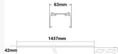
**Spécificités:** 8 x 2.5qmm précâblés (L1 / L2 / L3 / L' / N / PE / Dim+ / Dim-), sans couvercle
