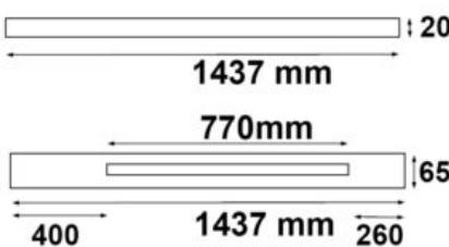
Spécificités: Module d'adaptation pour projecteur sur rail 3PH, rail de montage de 70 cm, phase réglable à l'arrière.
