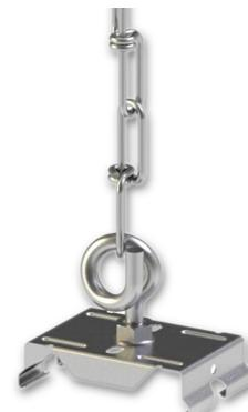
**Spécificités:** Le système linéaire, c'est-à-dire tous les supports de poutre et les connecteurs, est ancré horizontalement et fixé les uns aux autres. Lors du montage, une fixation à l'illet ou au clip doit être appliquée au moins tous les 2,3 mètres.
